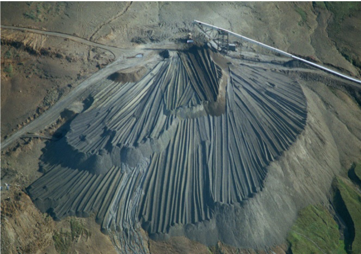
Haugssvæði ofan Aðganga III. Þessi staður þótti henta vel til haugsetningar þar sem hálsinn milli Glúmsstaðadals og Þuríðarstaðadals hallar þarna aflíðandi til norðurs og austurs og var ógróinn á þessum stað. Form á yfirborði haugsins mynduðust þegar jarðýta ýtti efni frá enda færribands.
